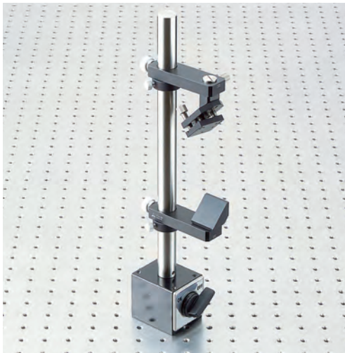
上側ミラー可動(光軸を下げる一般的なアプリケーション)
