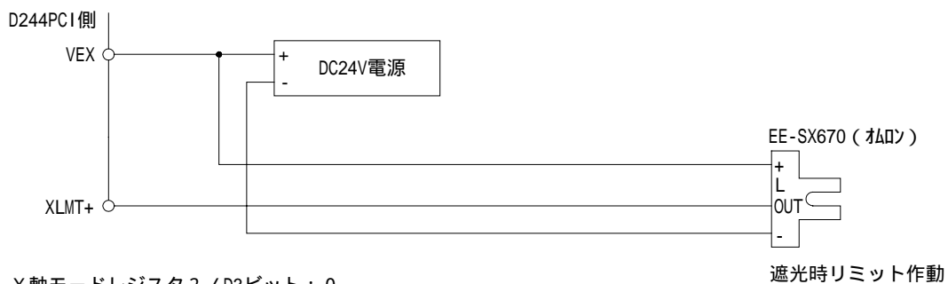
オーバランリミット入力信号とフォトマイクロセンサとの接続例
